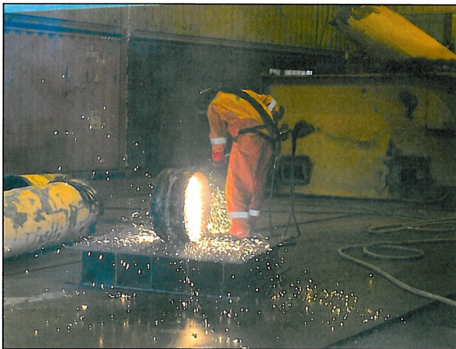
Figur 2: Brenning av prøvestykke. Legg merke til at glødende materiale fra prøvestykket spres utover i nærområdet. Sveiserøyken skimtes også i lufta over og til venstre for operatøren.
